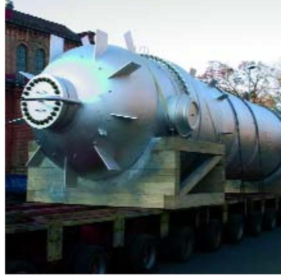
Компания **BORSIG Process Heat Exchanger** поставляет аппараты охлаждения газа высокой температуры (до 1500°C) и высокого давления (до 35000 кПа = 357 атм.) для химической и нефтехимической промышленности. Эти аппараты используются на различных технологических стадиях при производстве химикатов. Они напрямую соединяются с крекинг-печами и/или реакторами. Техника BORSIG применяется также в современных процессах газификации угля.
